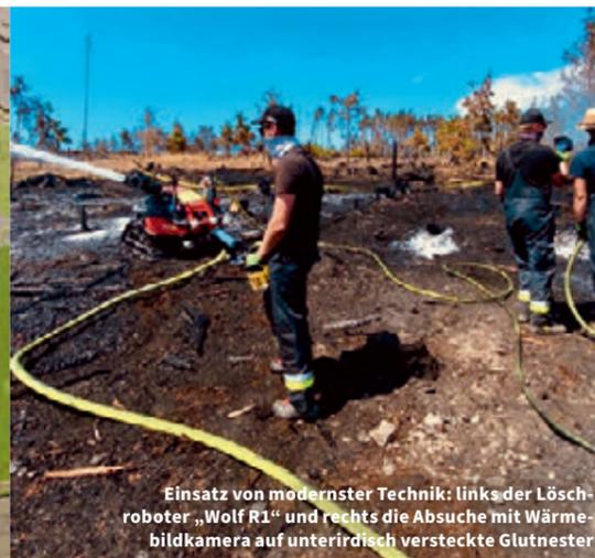
Einsatz von modernster Technik: links der Löschroboter „Wolf R1“ und rechts die Absuche mit Wärmebildkamera auf unterirdisch versteckte Glutnester
