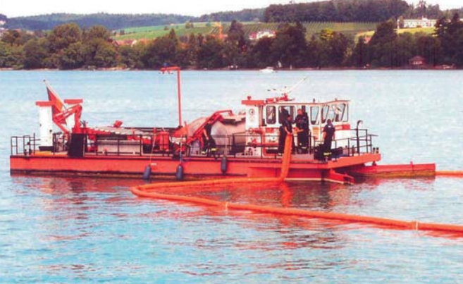
Selbstfahren- des Ölabsaug- gerät - SÖG - am Bodensee.
