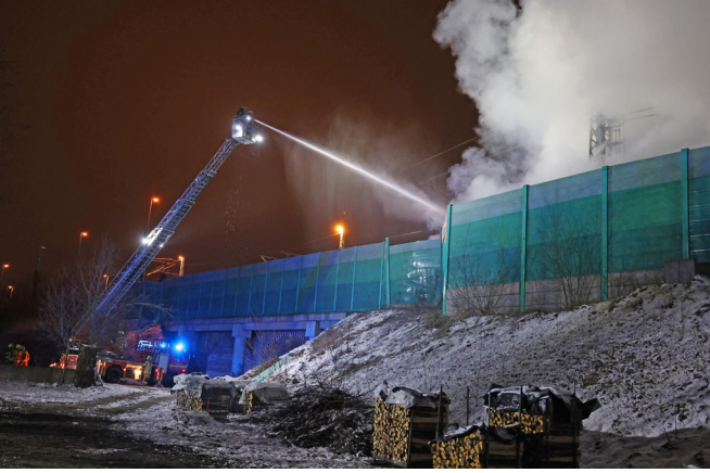
Bild o. und u.: Brandbekämpfung von Norden her über die Drehleiter mittels Wenderohr
