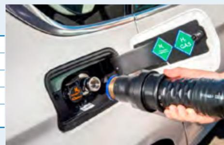
dem PKW oder im Kofferraum verbauten Druckgasbehältern aus Verbundwerkstoffen bei einem Druck von ca. 16 bar. Erkennungsmerkmale können die Fahrzeugbeschriftung, eine zusätzliche Tankklappe oder eine zweite Tankfüllstandsanzeige auf dem Armaturenbrett sein. Um ein Bersten des Wasserstofftanks
